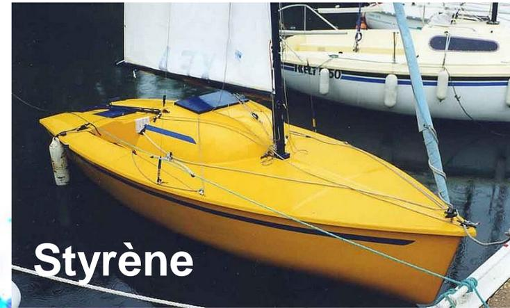
(résine de polystyrène renforcée à la fibre de verre)
